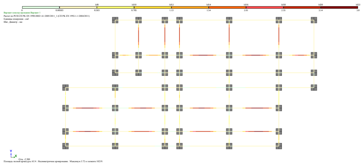
Рис. 10 Площадь полной арматуры AU4 . Несимметричное армирование . Максимум 3.72 в элементе 10219.
