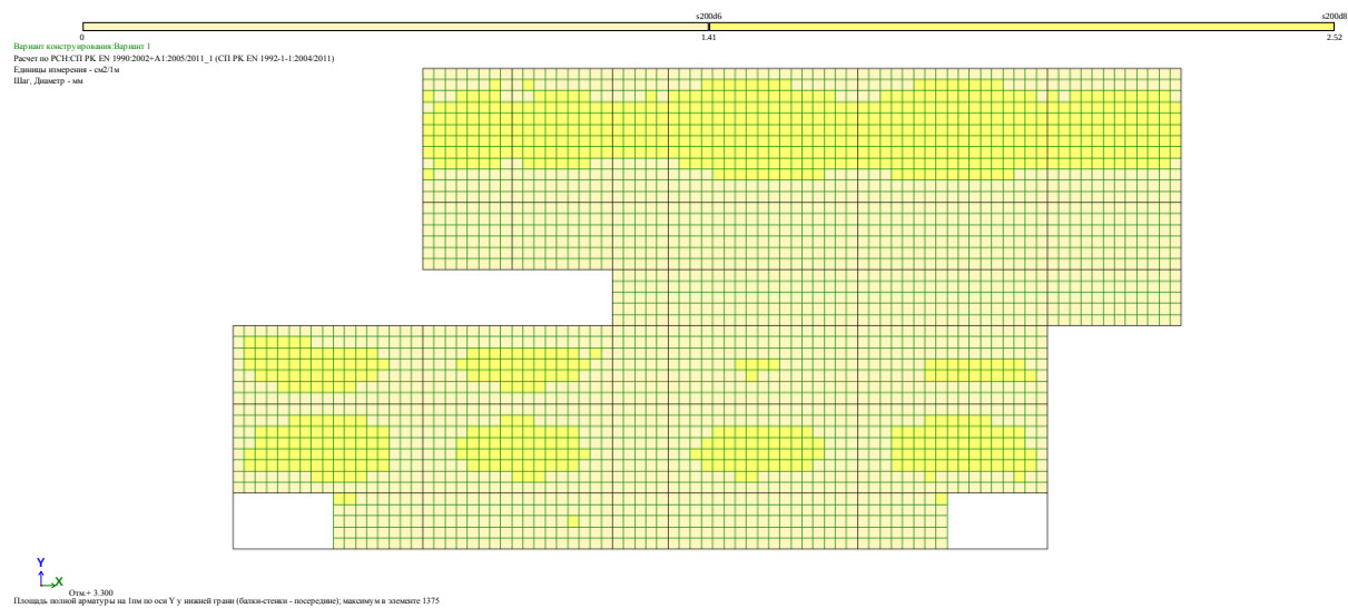
Рис. 19 Площадь полной арматуры на 1м по оси Y у нижней грани (балки-стенки - посередине)(2)
