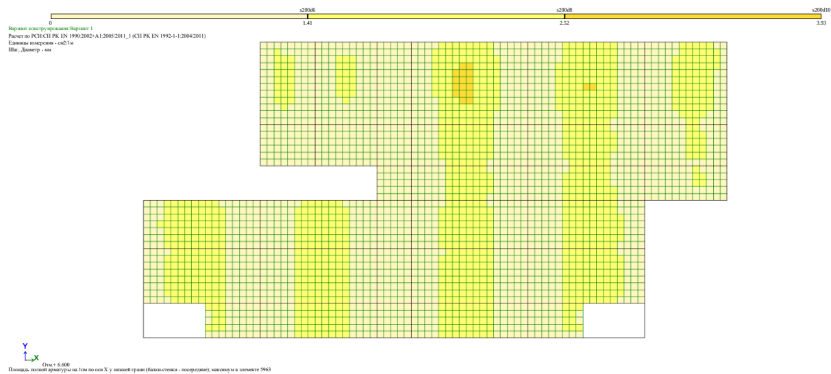
Рис. 27 Площадь полной арматуры на 1м по оси X у нижней грани (балки-стенки - посередине)(3)
